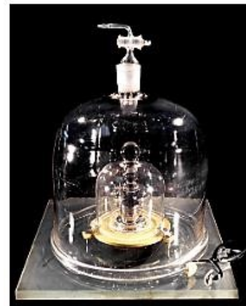
O Protótipo Internacional do quilograma (IPK), um cilindro de platina iridiada guardado no BIPM, em França Cortesia do BIPM
