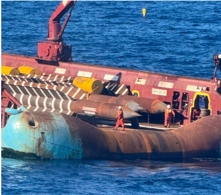
Figura 57 - Deslocando um Torpedo até a popa. Como não tem olhal na ponta, deve ser arrastado pela parte de atrás; porém, não necessariamente se arrasta pelo olhal de ré por não ter olhal à vante, geralmente se utiliza o de ré pela
