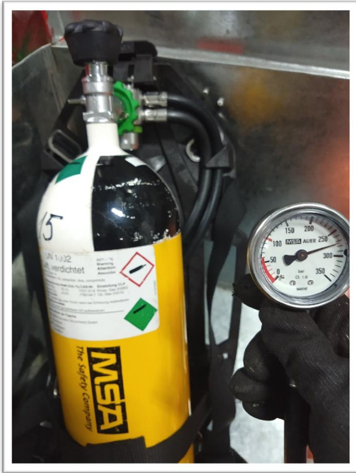
Figura 15: Teste do equipamento de respiração autônoma.
