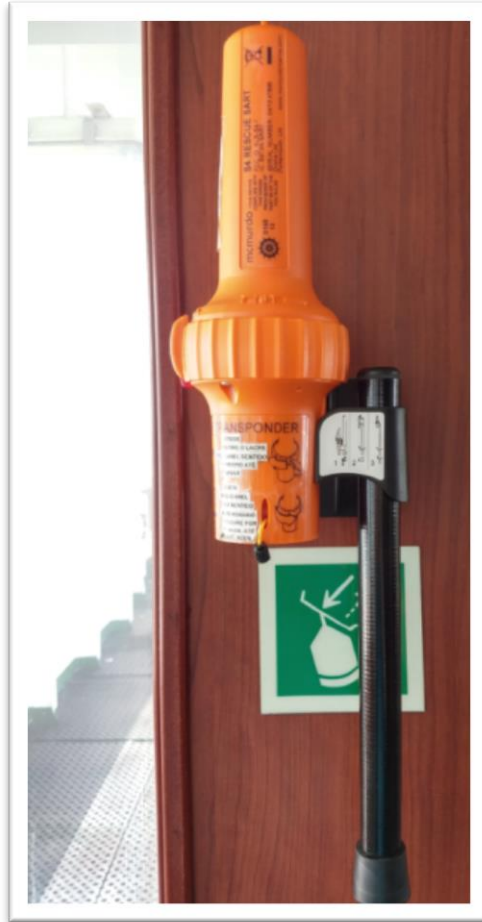
Figura 11: SART. Devem ser prontamente conduzidos para as embarcações de sobrevivência em caso de sinistro.
