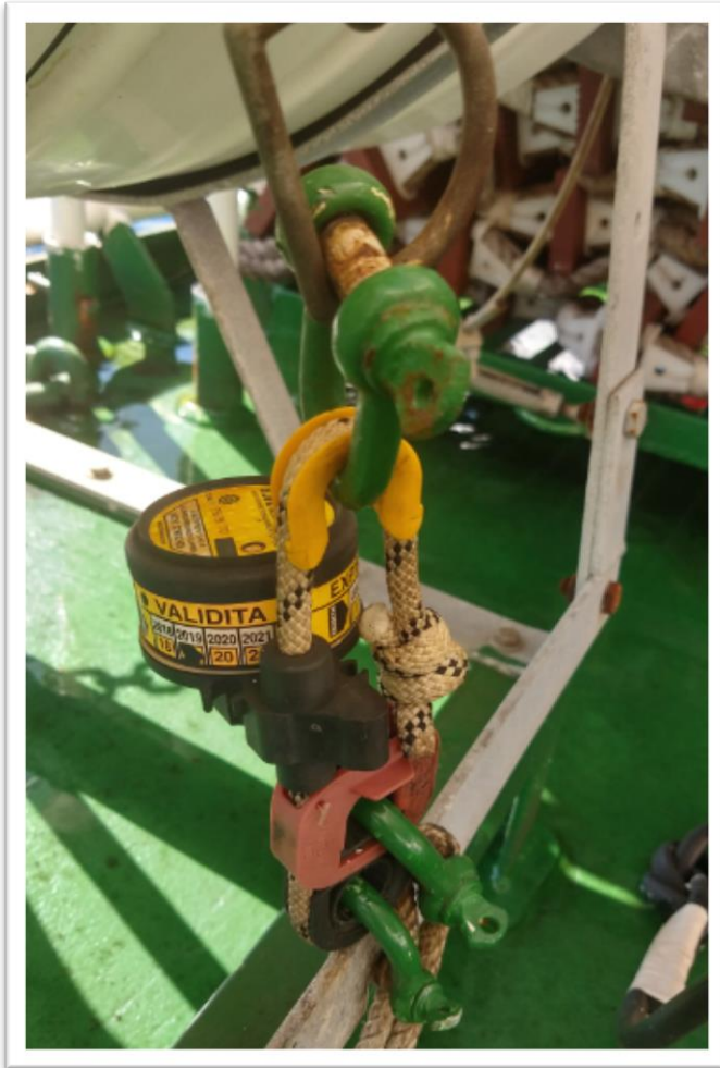
Figura 26: painter line da balsa preso ao dispositivo HRU.
