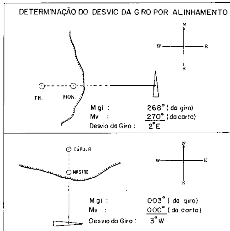
Figura 3.40 - Determinação do desvio da giro por alinhamento
