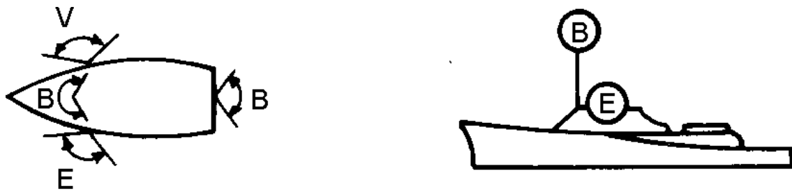
Figura 15.5 (a) - Vista de topo e de bombordo de uma embarcação de propulsão mecânica menor do que 50 metros, em movimento
