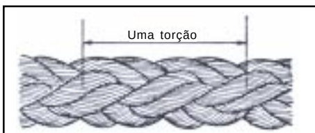
Fig. 7-19 – Comprimento da torção de uma perna de um cabo trançado
