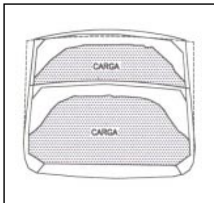
Fig. 5-24b – Esforços devidos à carga mal distribuída
