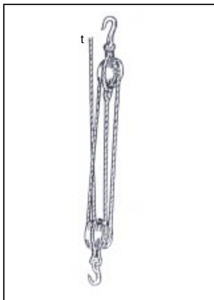
Fig. 9-18 – Talha singela (tirador saindo do cadernal móvel)
