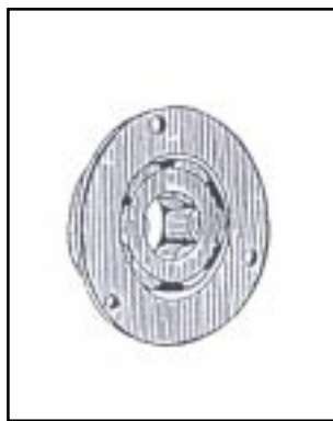
Fig. 9-14 – Roldana de bucha com redutor de atrito
