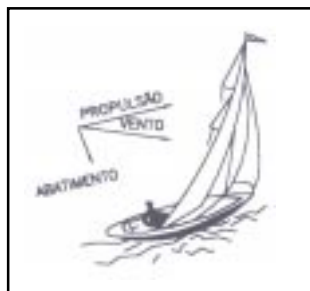
Fig. 5-26 – Esforços sobre as velas
