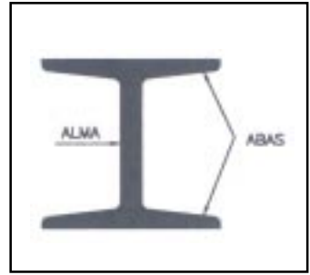
Fig. 5-2b – Alma e abas de um perfil "I"
