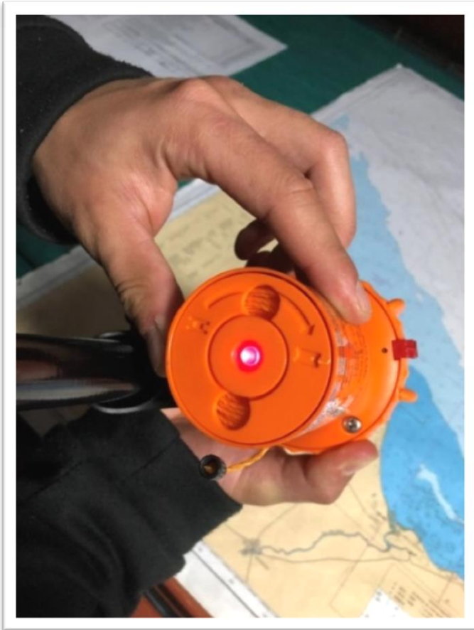
Figura 12: teste do SART. Deve-se girar o anel no sentido indicado e segura-lo por 30 segundos.
