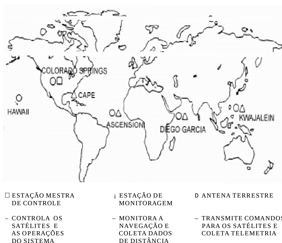
Figura 37.5 – Segmento de Controle do Sistema GPS
