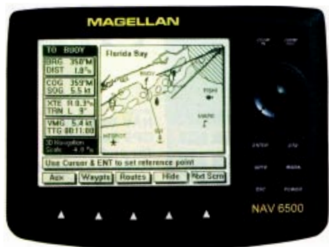
Figura 37.12 – Receptor GPS Magellan NAV 6500 Chartplotter (10 Canais) com Plotagem em Carta Digitalizada e Outras Capacidades
