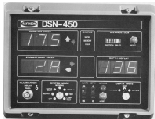
Figura 38.19 – Sistema Doppler de Navegação (“DOPPLER SONAR”)
