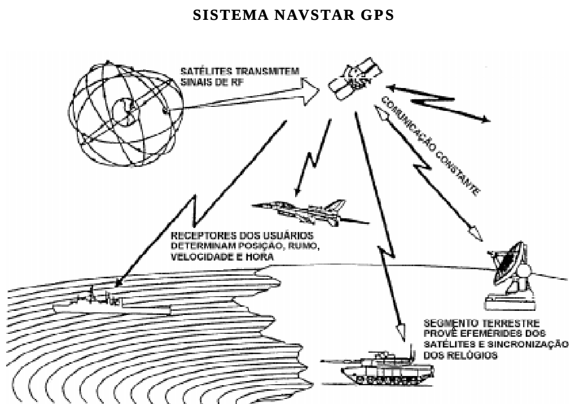
Figura 37.1 – Componentes do Sistema NAVSTAR GPS
