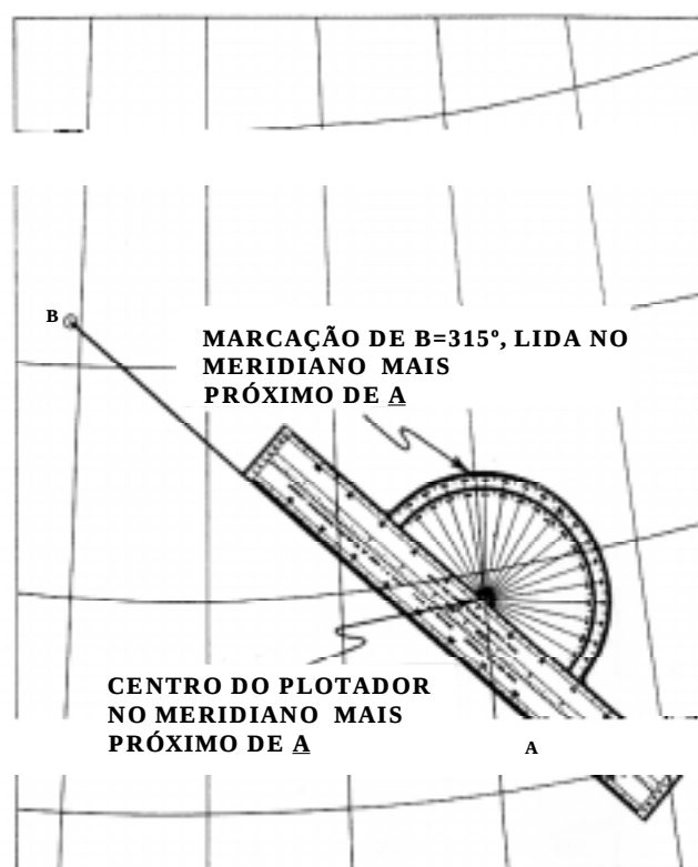
Figura 41.6 b – Medida de Marcação na Carta Conforme de Lambert
