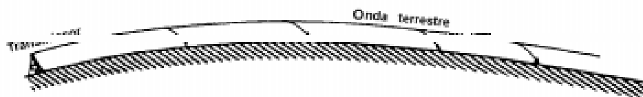
Figura 34.12 – Absorção da Onda Terrestre pelo Terreno
