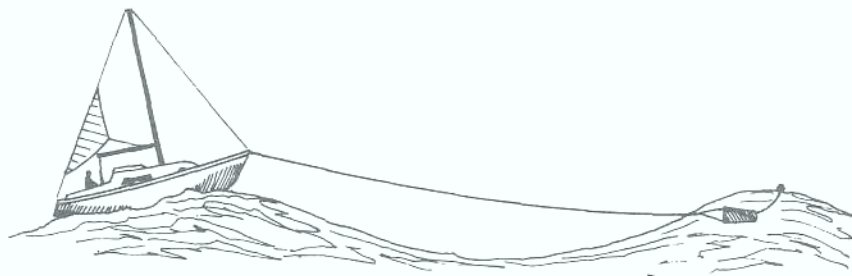
Lançar “âncora de mar” pela proa procurando ajustar o comprimento do cabo ao comprimento das ondas
