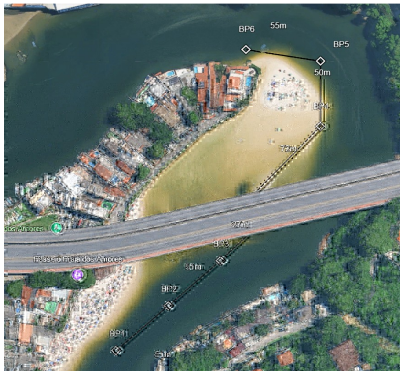
: i; #ra 21 " Posicionamento das *oias do cord-õ de se ara. -õ na Praia dos Amores
